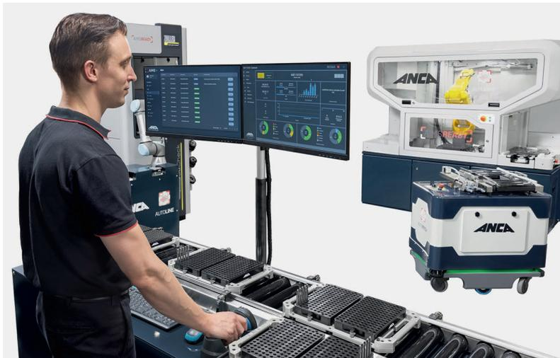
Die 'Autoset' genannte Station zur Arbeitsvorbereitung enthält den Aims-Server mit Anca-eigener Software-Suite für Datenschnittstellen und Monitoring
